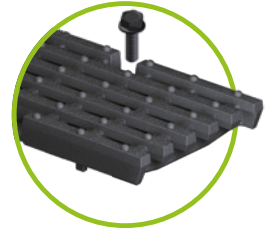
Guss-Längsstabrost MW 29/13 – NW 100 & 150 MW 25/13 – NW 150 bis Kl. D MW 22/13 – NW 150 & 200, bis Kl. E 4-fach verschraubbar nur in Gusszarge möglich
